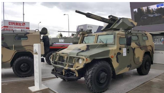
Рисунок 10 – Бронеавтомобиль «Тигр-М» с 30-мм дистанционно-управляемым боевым модулем
