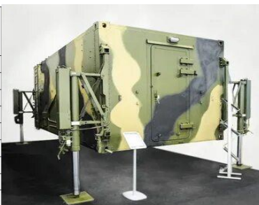
Рисунок 6 – Параметры съемного кузова – контейнера адаптированного к базовому шасси с колесной формулой 8x8
